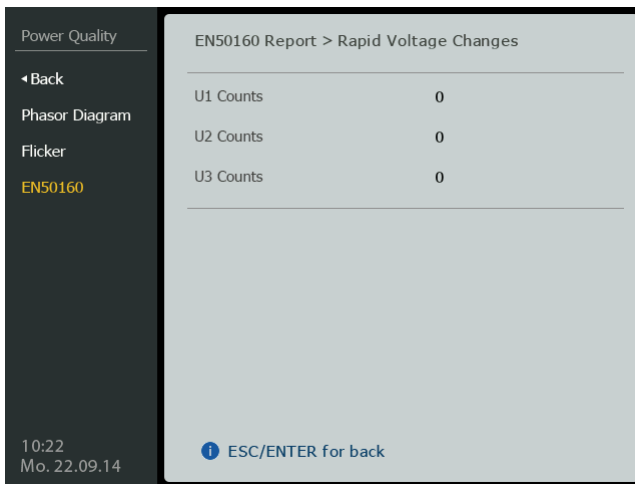
Fig. 7.9: Rapid voltage changes (subpage)
